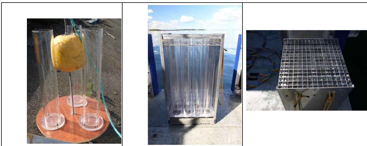
Figur 1: Eksempel på utforming av sedimentfeller. Bildet til venstre viser standard sedimentfelle som plasseres på bunnen eller i vannsøyla. Bildet i midten viser større sedimentfeller for plassering på bunnen og bildet til høyre viser åpning med strømdemper i den større sedimentfellen.
