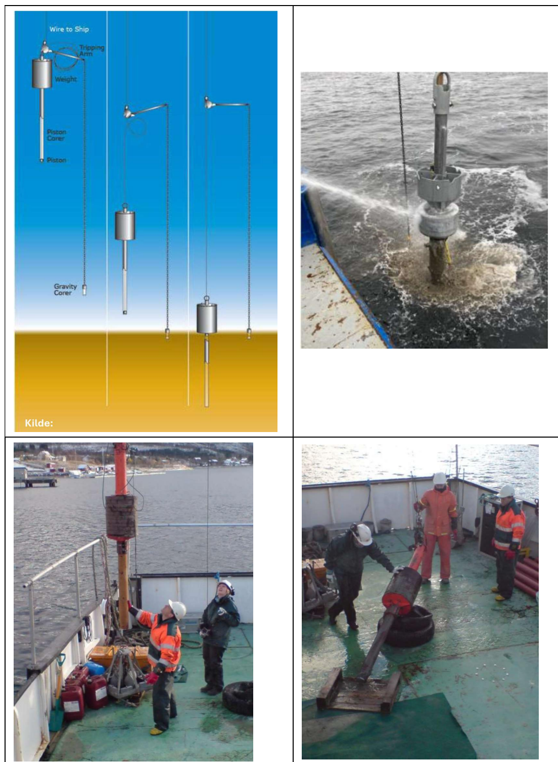
Figur 3: Prinsippskisse for prøvetaking med «Gravity Corer», samt Multiconsults «Gravity Corer» i bruk.
